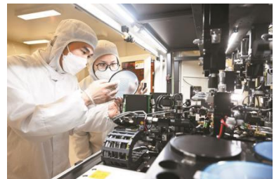
检修芯片测试机设备
